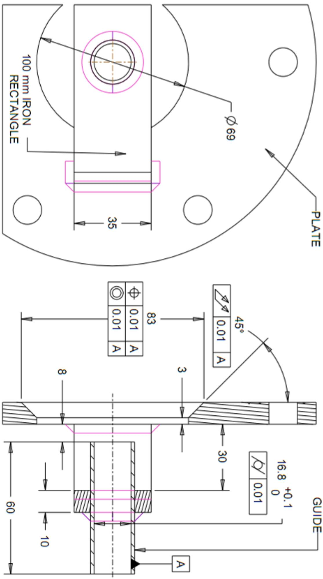
**Scale: 1.000 IMPULSE VALVE STOP BAR 2"**
